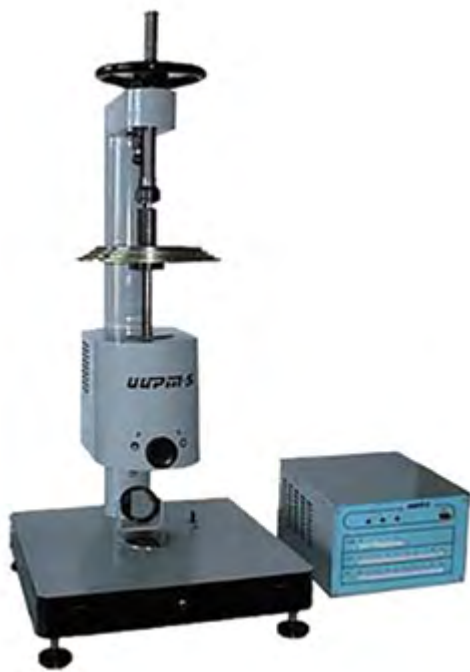
Рис. 1. Прибор для определения показателя текучести расплава полимерной основы.
