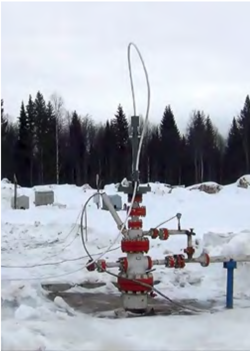
Рис.8. Выход нагревателя через лубрикаторный узел
