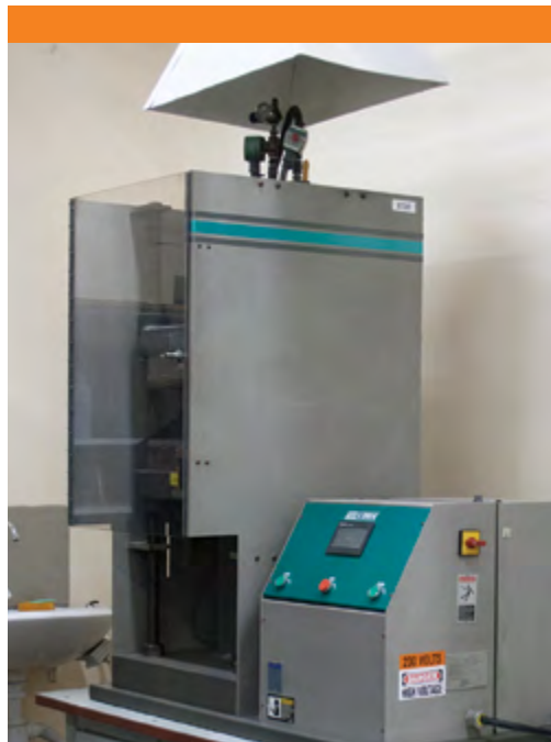
Рис. 2. Внешний вид лабораторного пресса для изготовления тестовых образцов.
