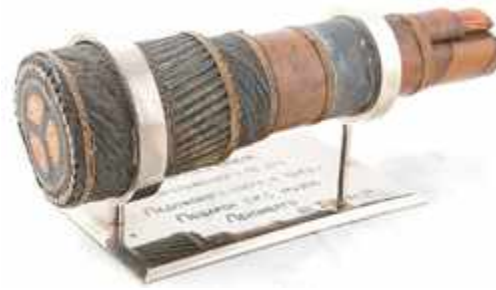
Рис. 2 Внешний вид силового подводного «кабеля жизни» СКС 3 x 120 мм, на 10 кВ
