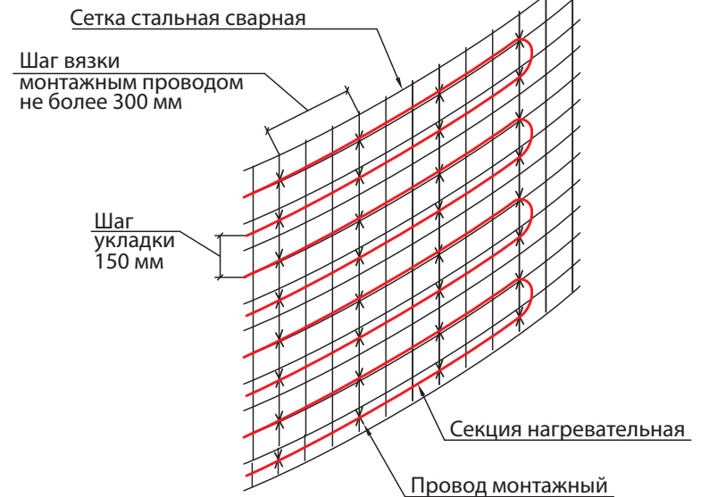
Узел монтажа нагревательной секции на стальной сетке
