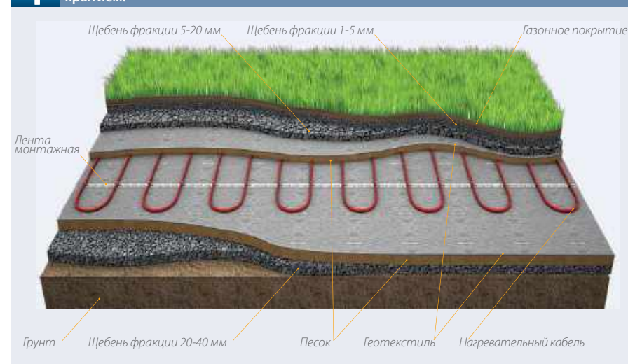
Рис.3. Схема обогрева футбольного поля с искусственным покрытием.
