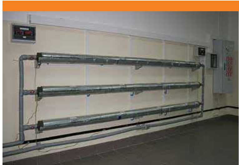
Рис. 7. Испытательный стенд для определения выходной мощности и стартовых токов саморегулирующихся кабелей.
