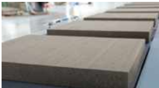
Рис. 4 Изготовление изделий с помощью струнного станка
