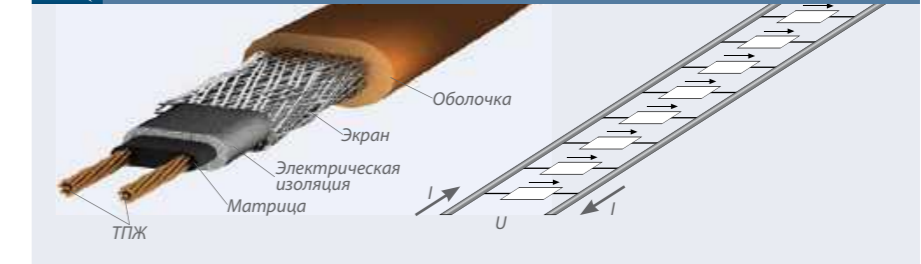
Рис. 1. Внешний вид и схема саморегулирующегося нагревательного кабеля
